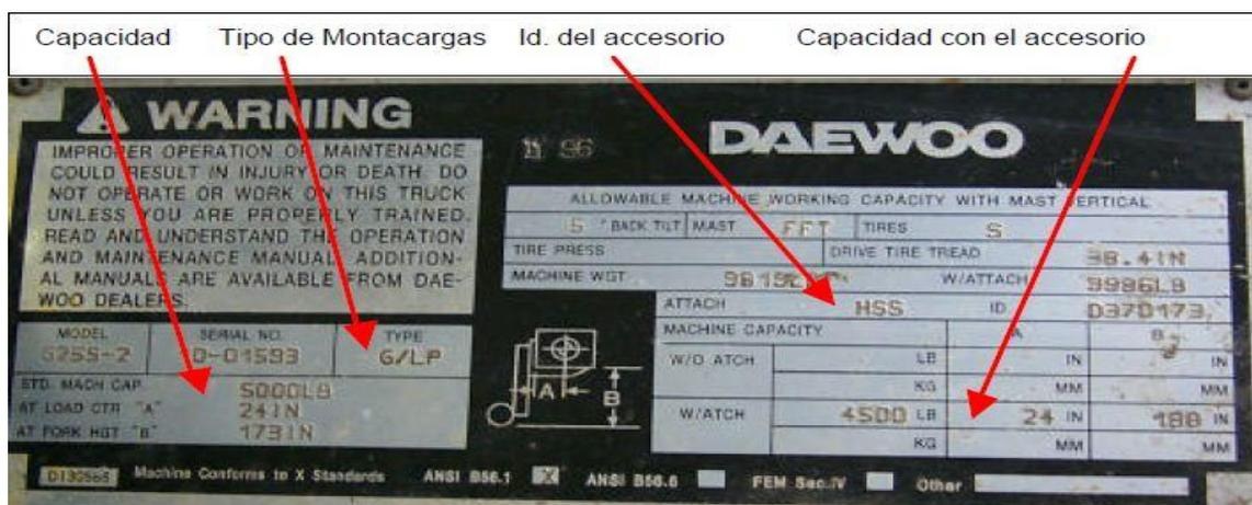
Este montacargas de gas propano puede levantar de manera segura 5,000 libras. 173' pies de altura con un centro de gravedad de 24" desde el frente de las horquillas etiquetado "HSS", la carga de seguridad baja hasta las 4,500 libras.
