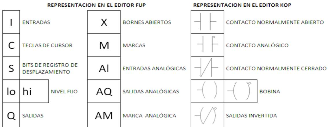
Figura V0.7 Constantes y bornes de conexión.
