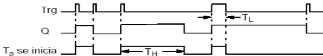
**Figura V41** Diagrama de temporización de la función interruptor comfortable.
