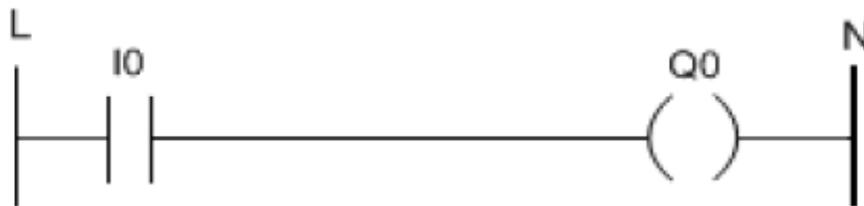
**Figura V44** Programación Ladder para encender una lámpara.
