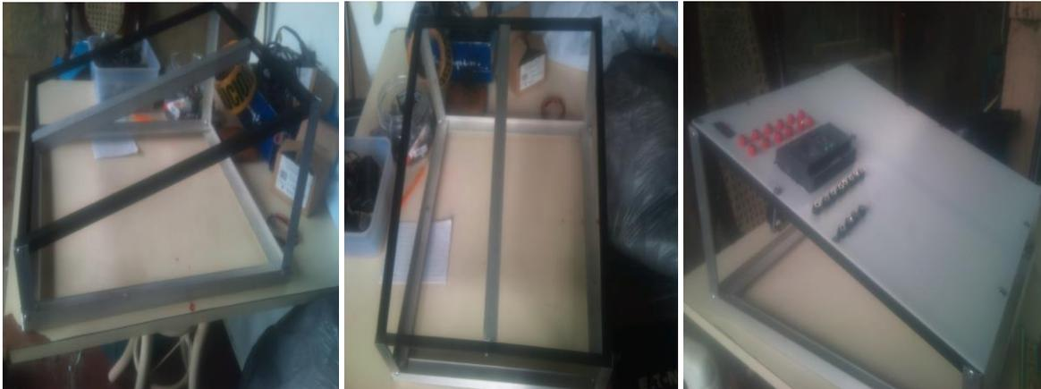
**Figura III.07** Vista de la base con perfiles de aluminio terminado y montaje del acrílico y componentes.
