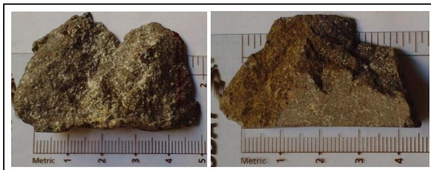
Figura 7. Muestra de mano M5-2406. Andesita de textura porfirítica correspondiente a la zona suroeste de la estructura caldérica La Joya. Coordenadas: X 519225 Y 1392923.
