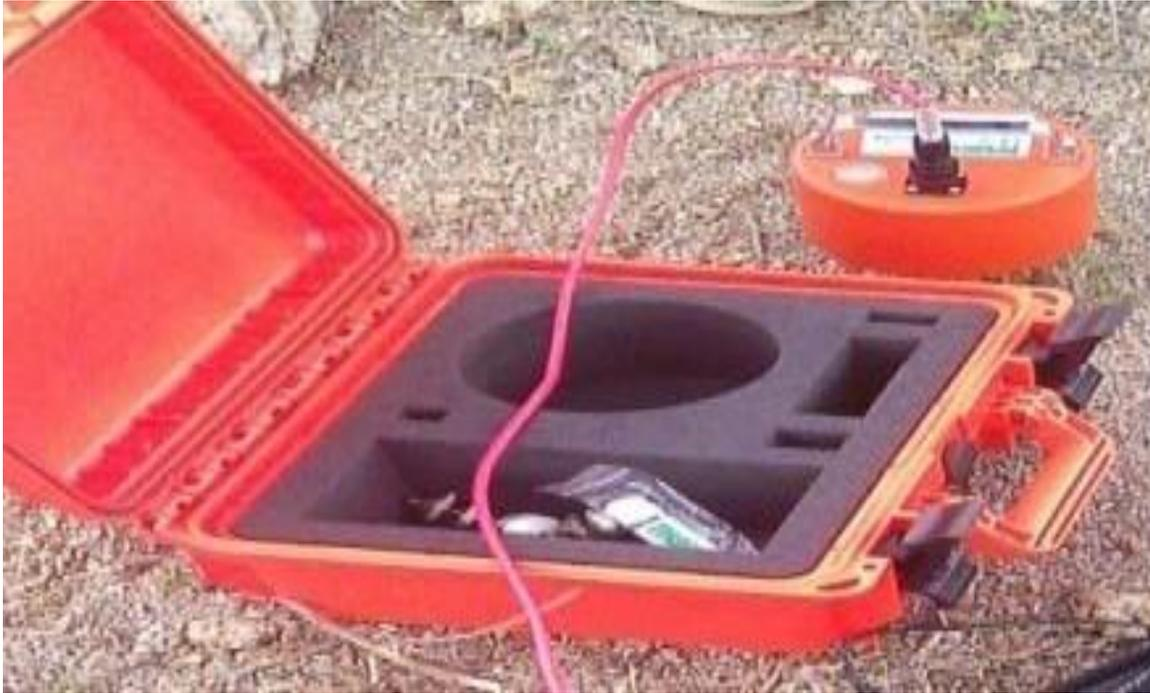
*Equipo de Medición Para Microtremores, sismógrafo triaxial Gemini-2 con
