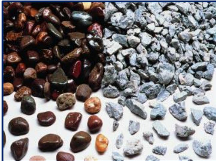
Fig. 6. Agregado grueso. Grava redondeada (izquierda) y piedra triturada (derecha). Pág. 103 “Diseño y Control de mezclas de concreto PCA”.
