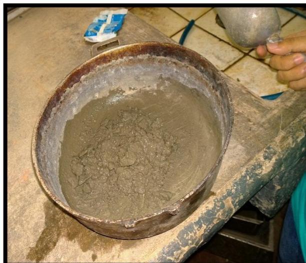
Luego de determinar el porcentaje de cada agregado se colocaron en bolsas con la cantidad precisa y listas para ser mezcladas con la cantidad de agua especificada por las tablas de diseño utilizadas.
