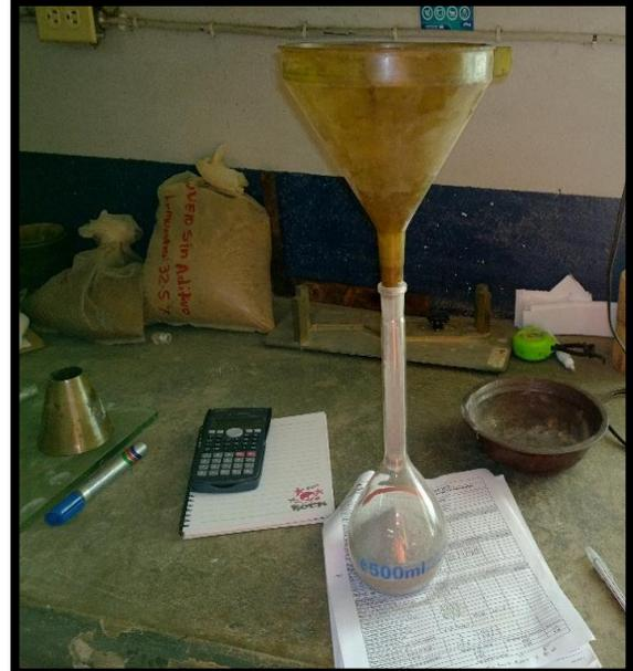
En la imagen de la izquierda se aprecia el registro del peso del picnómetro más agregado y placa metálica. En la imagen de la derecha se observa la incorporación de una cierta cantidad de agua denotada por la graduación del picnómetro para poder retirar el aire atrapado entre las partículas de agregado fino.
