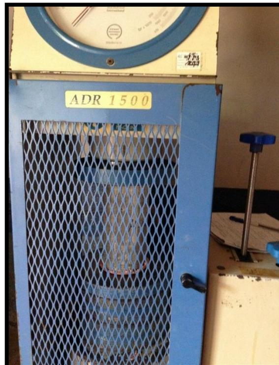
Toma de lectura de la resistencia obtenida luego del fallado del espécimen y revisión del tipo de falla.
