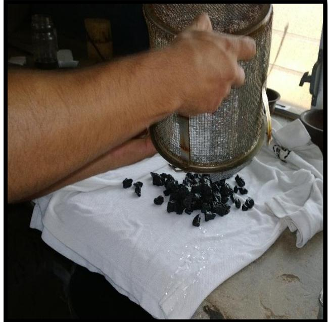
En la siguiente imagen se muestra el secado de los agregados en la cocina utilizando una placa de vidrio para verificar si el agregado ya está completamente libre de humedad y poder determinar el porcentaje de absorción.
