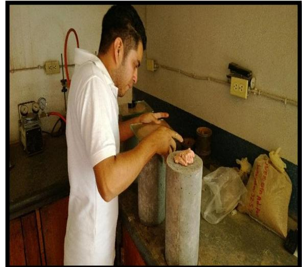
Se realiza un chequeo del nivel del material (yeso #4) colocado como base para distribución de la carga en ambas bases.
