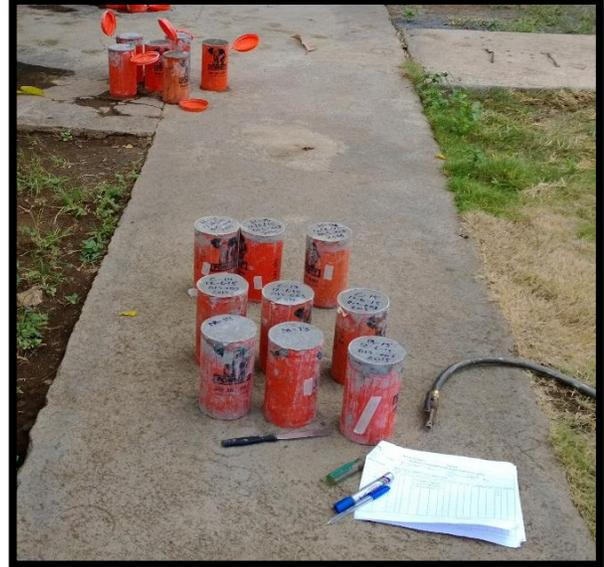
Se procede a realizar la extracción de los especímenes de cada uno de los moldes según edad establecida. A los dos tipos de moldes se les aplicaron aceite para evitar la adhesión del concreto y poder retirar los especímenes sin daño alguno, los especímenes de los moldes pequeños se extraen con un compresor inyectándoles aire por el orificio de la base del molde.
