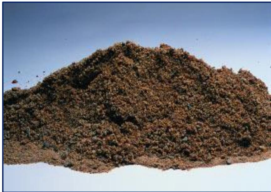
Fig. 5. Primer plano de agregado fino (arena). Pág. 103 “Diseño y Control de mezclas de concreto PCA”.
