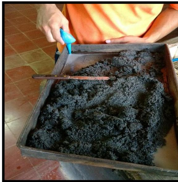
En las siguientes imágenes se ve el proceso de secado superficial del material, utilizando un abanico y moviendo el agregado para que tenga un secado homogéneo para posteriormente comprobarlo con el método del cono truncado.
