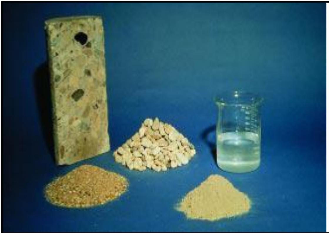
Fig. 1 Componentes del concreto: cemento, agua, agregado fino, agregado grueso, son combinados para formar el concreto. Pág. 1 “Diseño y control de mezclas de concreto PCA”
