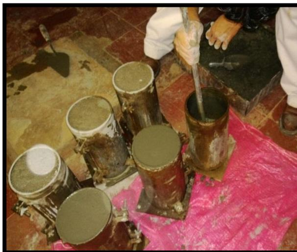
En estas imágenes se observa el llenado de los especímenes aplicando golpes leves con un mazo de hule para el acomodo de las partículas. Posteriormente, enrazando y colocando el distintivo inicial a cada espécimen fabricado (moldes de 12" por 6").
