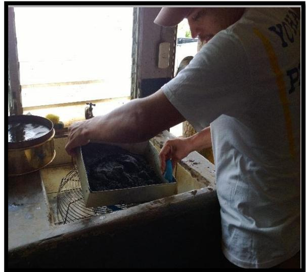
En las siguientes imágenes, podemos apreciar el secado en cocina del material lavado por el tamiz número 200 y luego tamizado por una serie de tamices especificados.
