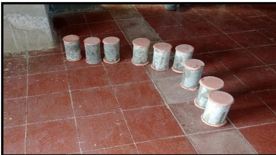
Luego de la ruptura de prueba de cada espécimen se verifica el tipo de falla y se determina si el agregado y demás componentes de la mezcla están trabajando adecuadamente según sus características.
