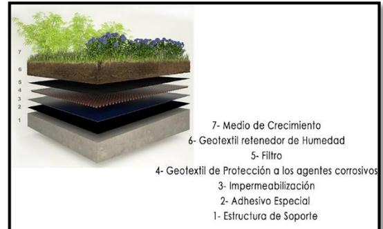
La cubierta verde propuesta contribuirá al ahorro energético del edificio de muchas maneras, pues va a reduce el calor del edificio durante el verano. Las plantas y la tierra se evaporaran en el agua, creando un efecto de enfriamiento por transpiración y un aire más húmedo, más comfortable para respira.
