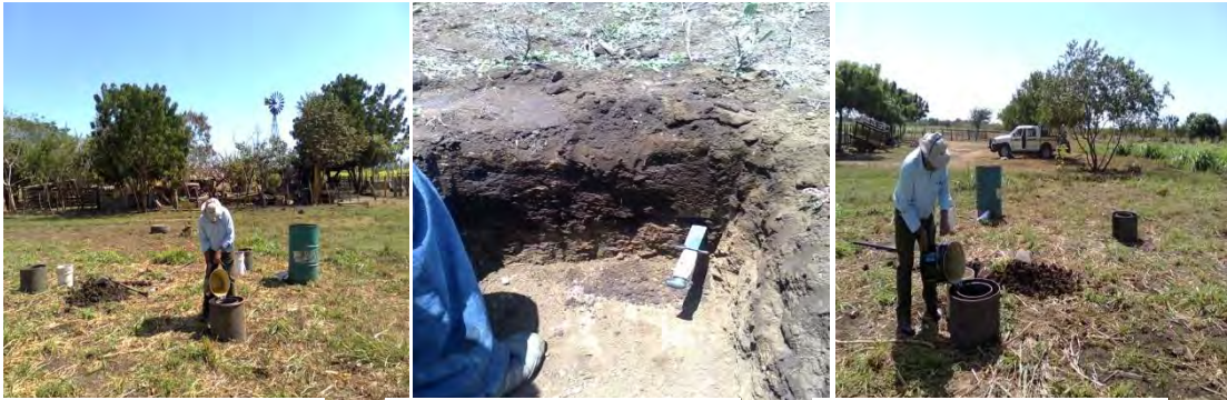
Foto2- Prueba de infiltración de cilindro
