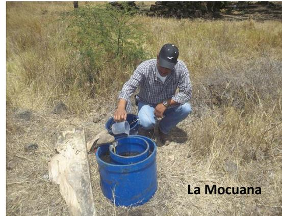
Foto 2. Prueba de infiltración usando los cilindros concéntricos.
