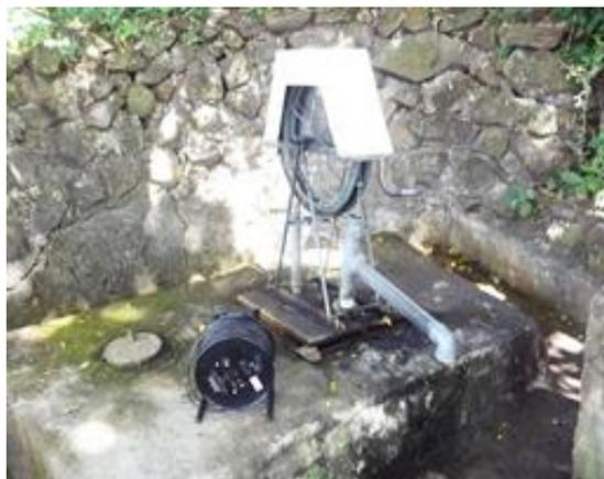
Foto 1. Sonda usada en la medición de Nivel Estático del Agua.
