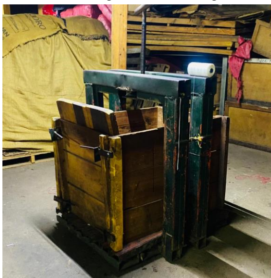
Figura 6. Maquina selladora de pacas de tabaco para la venta.
