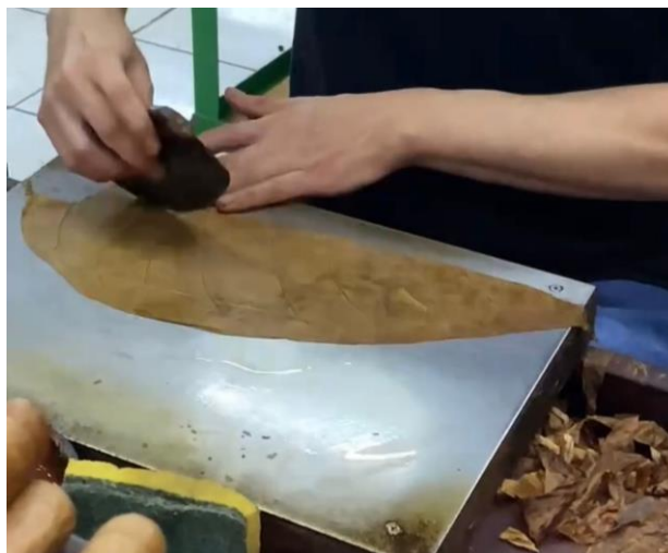
Figura 9. Tabla de rolado utilizada en el área de producción.
