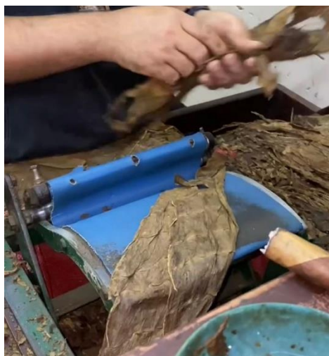
Figura 8. Máquina de bonchado utilizada en el área de producción.
