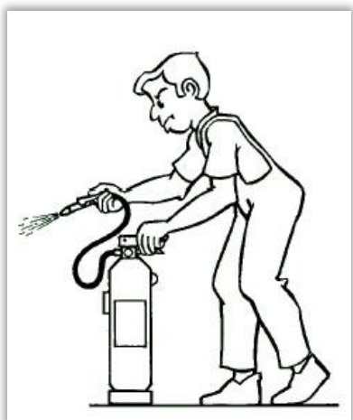
Ilustración 23. Descarga de comprobación.
