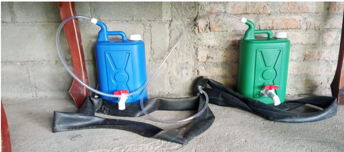
Figura 11 Relación 1:1 y 1:2 en mini biodigestores de prueba.
