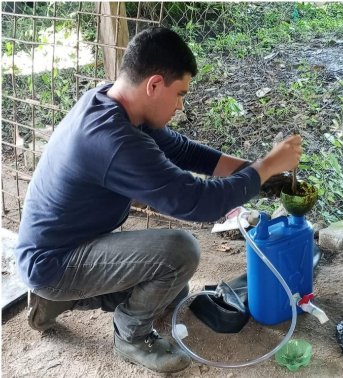
Figura 10 Llenado de pequeños biodigestores de prueba con distintas relaciones de sustrato.
