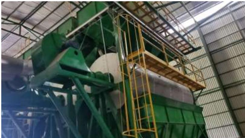
**Presecadoras verticales:** Están diseñadas específicamente para adelantar el proceso de secado del café en grano (café pergamino), permitiendo que las operaciones de secado sean más rápidas y eficientes.
