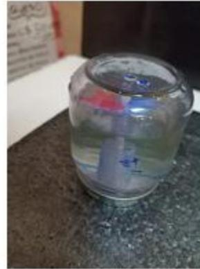
11- Una vez terminada la aguja, colocamos agua en el frasco de vidrio el tanto de dos pulgadas aproximadamente, luego tapamos el frasco con la tapadera donde se ha trabajado la aguja, la aseguramos bien y boteamos el frasco y por último lo fijamos en la base de poroplas.
