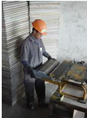
ILUSTRACIÓN 15. SECADO DE LA TEJA DENTRO DE LOS MOLDES
