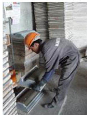
ILUSTRACIÓN 16. DESMOLDADO DE LA TEJA
