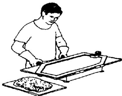
ILUSTRACIÓN 10. FIJAR EL MARCO DE A LA MESA AL PLÁSTICO
