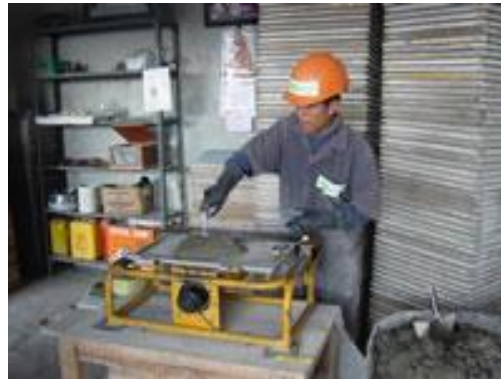
ILUSTRACIÓN 11. COLOCAR EL MORTERO SOBRE LA LÁMINA
