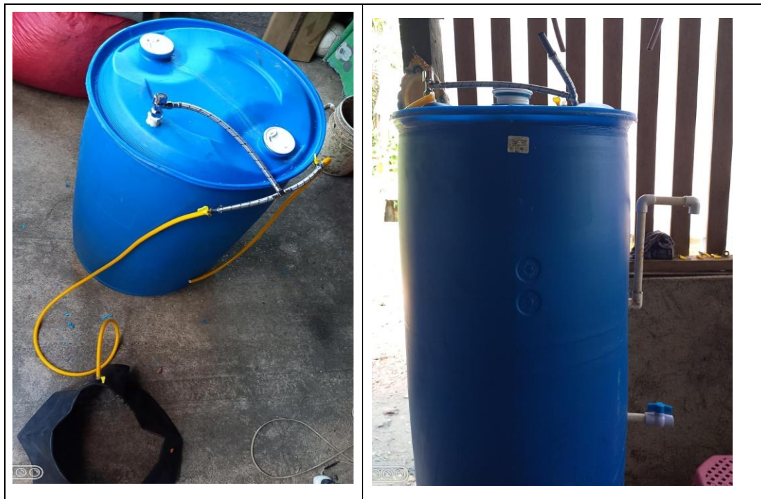
Figura 12: Biodigestor Fuente: Elaboración propia
