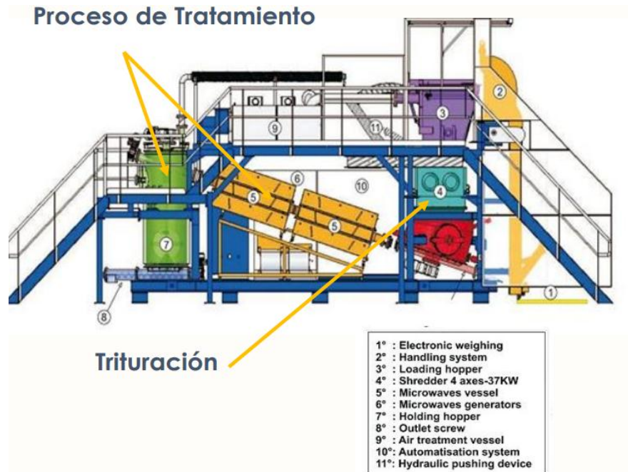
Figura8. Proceso de tratamiento de desinfección de desechos peligrosos por microondas, fuente: (Orozco, 2017)
