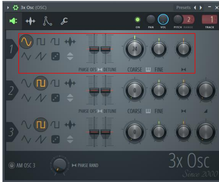
Figura No. 26 Parámetros del oscilador primario, en amplitud media y sin fases.
