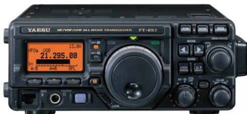
Figura No. 33 . Equipo de pruebas experimental transceptor multibanda HF-50MHZ, VHF y UHF. Potencia máxima de transmisión a 100W.
