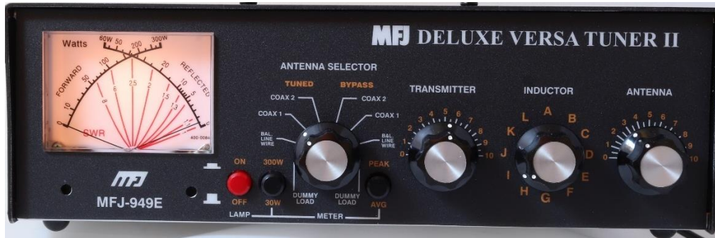
Figura No. 35 Acoplador de antena MFJ-949E, con selector de antena, opción de bypass y carga fantasma incorporada.
