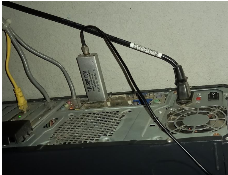
Figura No. 36 Equipo receptor con un analizador SDR remoto, visualizado vía escritorio remoto (RDP), corriendo en Windows server 2019 y ejecutando SDRSharp para la visualización del espectro radioeléctrico
