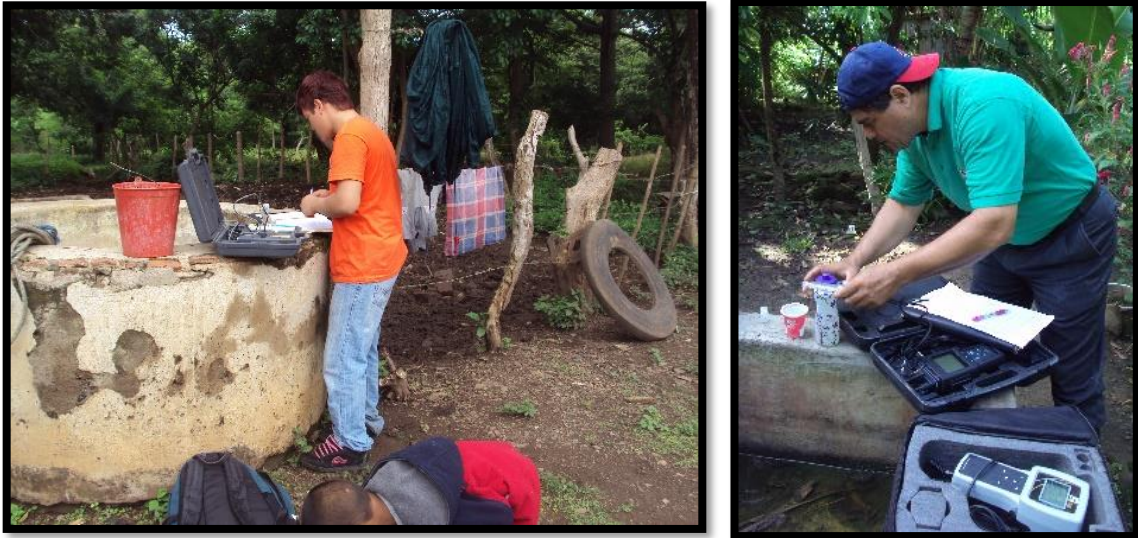
Foto 15. Medición de parámetros de campo en agua subterránea, en la unidad de cuenca del Río Papaturro.
