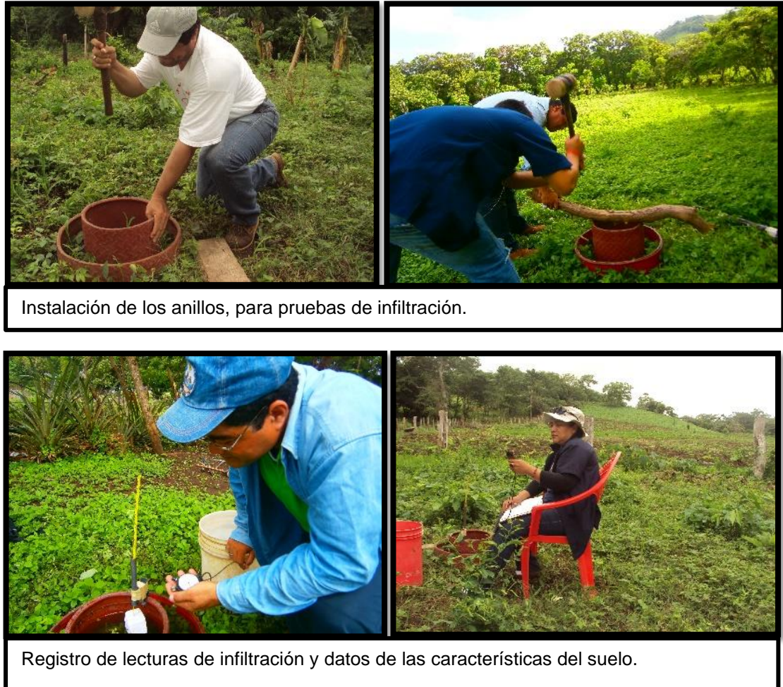
Foto 11. Pruebas de infiltración con doble anillo (instalación y lectura).
