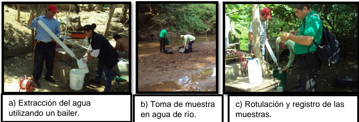
Foto 14. Colecta de muestras de agua superficial y subterránea, y medición de parámetros físico-químicos de campo.
