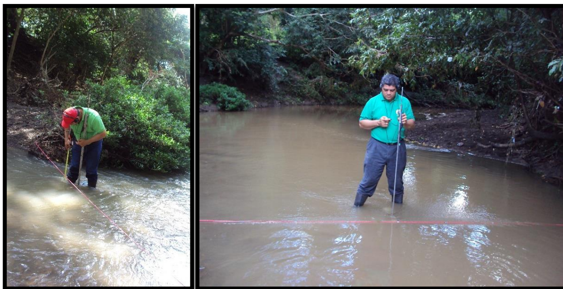
Foto 7. Determinación de la sección transversal y de la velocidad de flujo con molinete.
