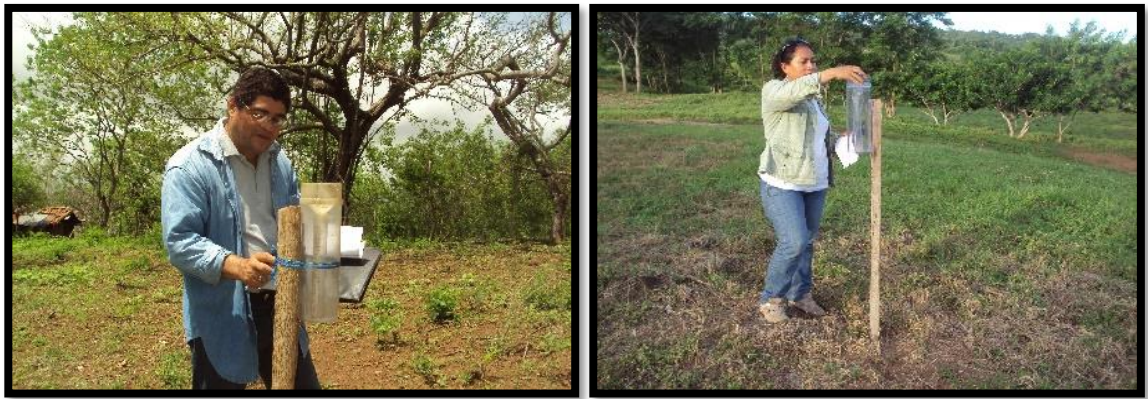
Foto 1. Instalación y lectura de pluviómetros en la unidad de cuenca.
