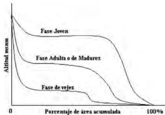
Figura 10. Cambio de forma en curva hipsométrica con la edad del río
