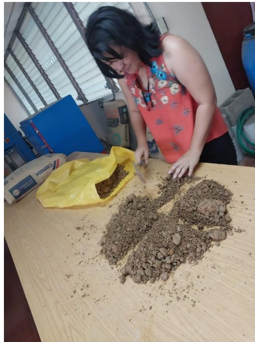
Anexo 2.2 Cuarteo de muestra para preparación de ensayos en laboratorio.
