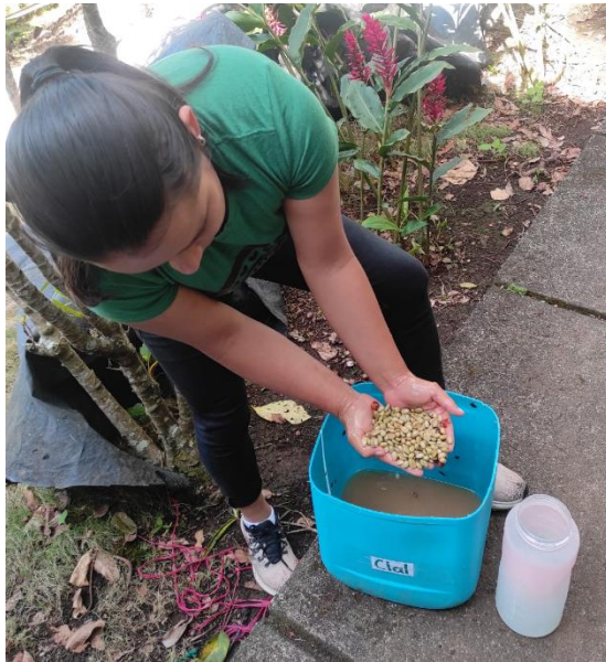
Fotografía 7: Lavado continuo por cada muestra midiendo el consumo de agua
