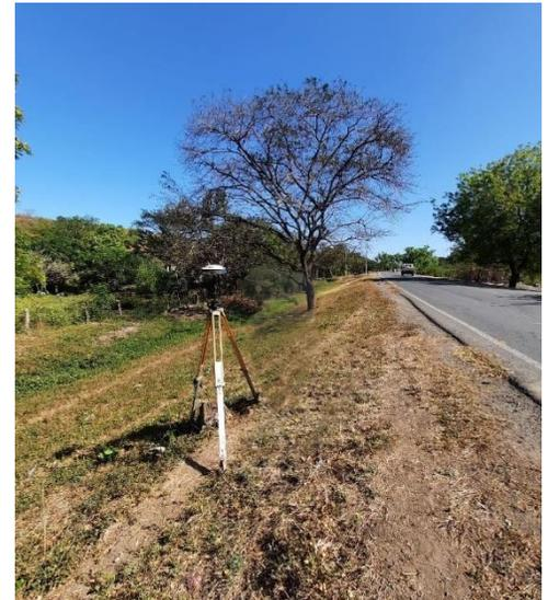
Ilustración 14: Georreferenciando con GPS doble frecuencia de BM-2 07/02/2021
