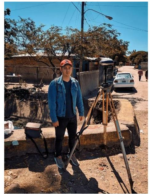
Ilustración 13: Georreferenciando con GPS doble frecuencia de BM-1 07/02/2021
