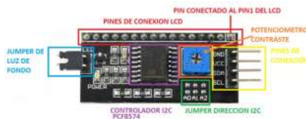
Figura. 33 Partes internas, Modulo adaptador LCD.
