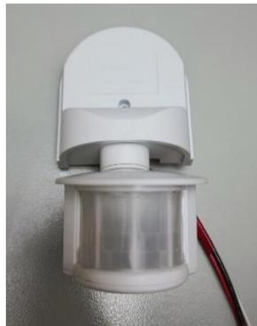
*Nota.* En la imagen se observa el sensor de movimiento PIR para la realización del laboratorio de iluminación inteligente.
