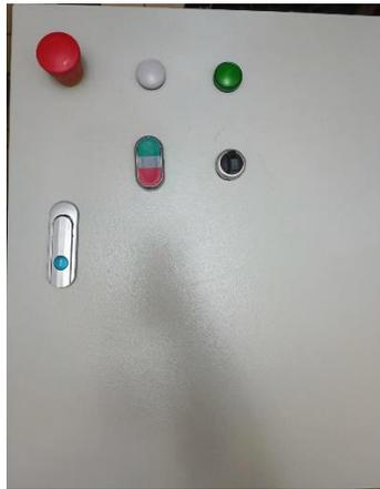
En la ilustración 38 se observa la cara frontal del entrenador, consiste en un panel eléctrico perforado al que se le acoplaron en la tapa componentes de control y señalización.
