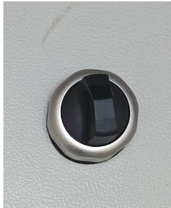
*Nota.* En la imagen se observa un selector eléctrico rotativo utilizado para cambiar el giro del motor.
