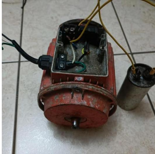
*Nota. Imagen de motor monofásico con condensador de arranque utilizado para demostración.*
