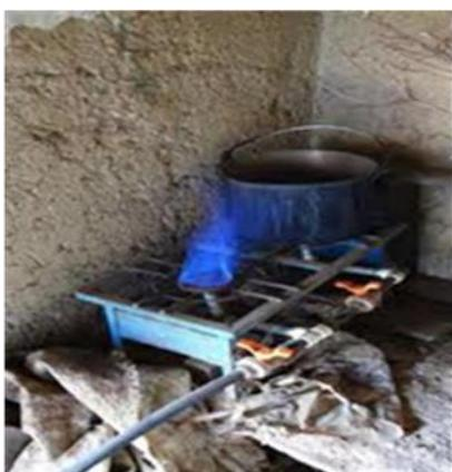
**Foto 4. Llama de la cocina con la utilización del biogás.**
