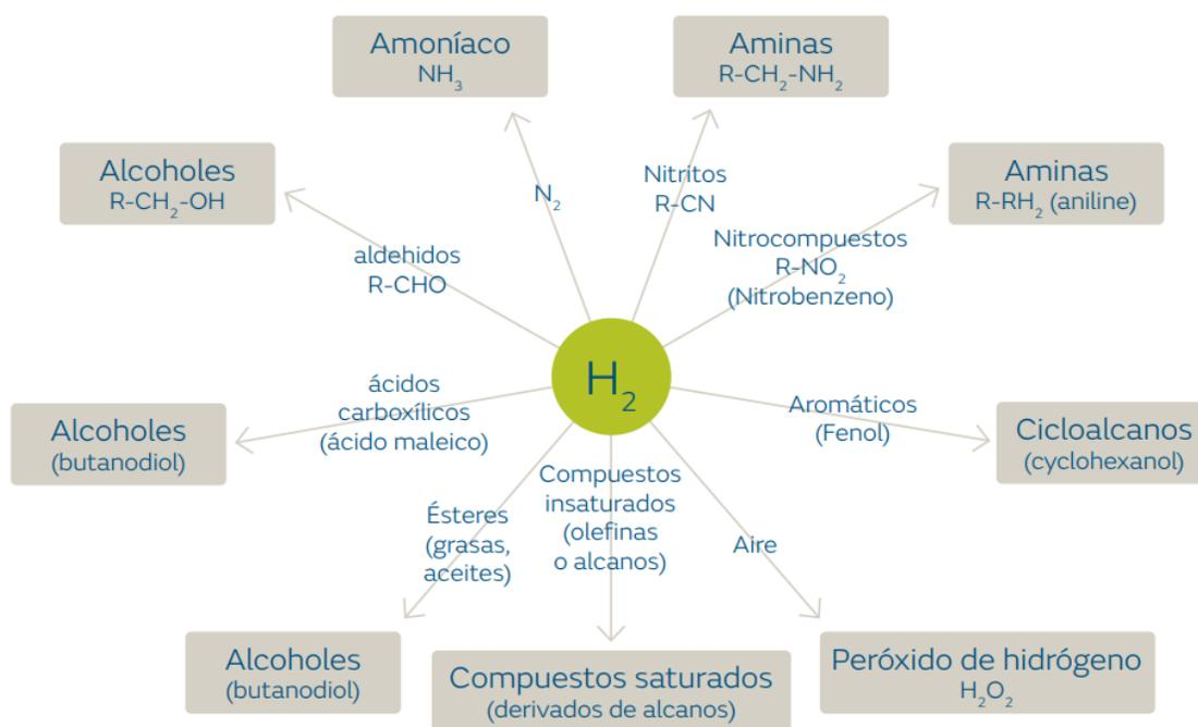
Figura 2.9. Vías de producción de compuestos químicos a partir de hidrógeno. Fuente: Tomante et al (2020)
