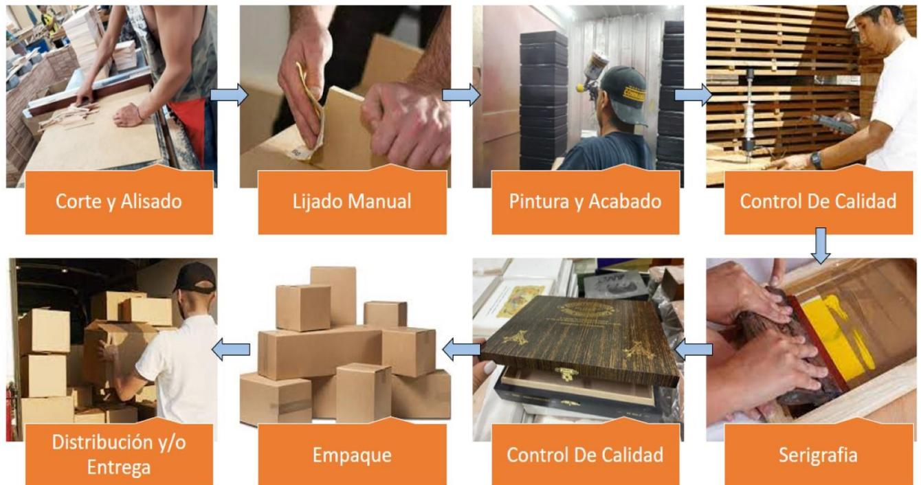
Figura 2. Flujograma proceso de producción
