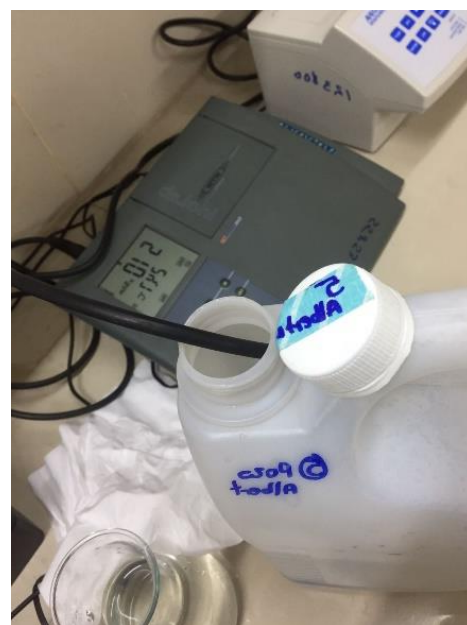
Ilustración 43 Análisis de conductividad
