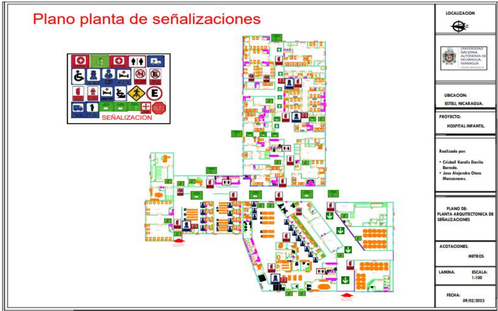
Plano de planta de Señalizaciones
