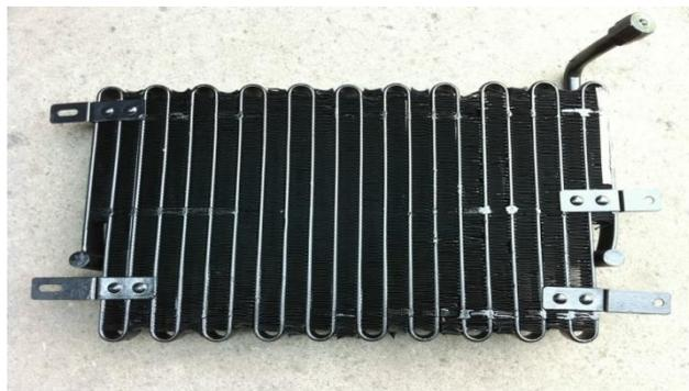
Figura 15 Condensador
