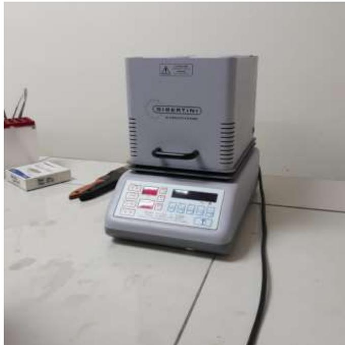
**Figura 16. Analizador de humedad <sup>a</sup>Eurotherm<sup>a</sup>**
