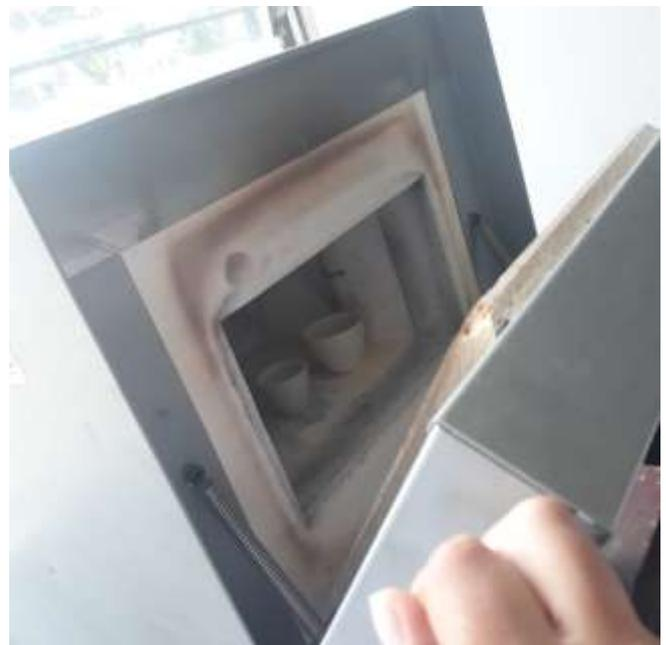
**Figura 4. Muestras de Cascarilla de Cacao en la mufla**
