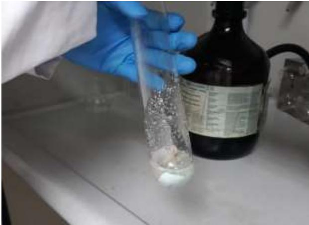
**Figura 8. Adición de Ácido Sulfúrico a los tubos de digestión**
