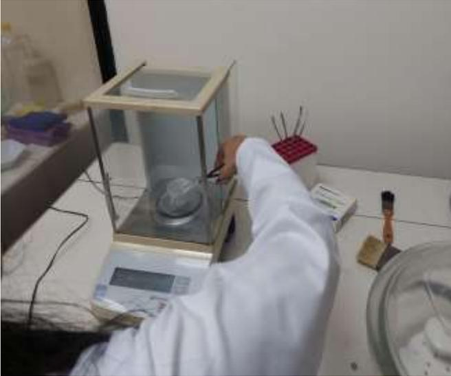
**Figura 1. Pesaje de la muestra de Cascarilla de Theobroma Cacao Trinitario.**
