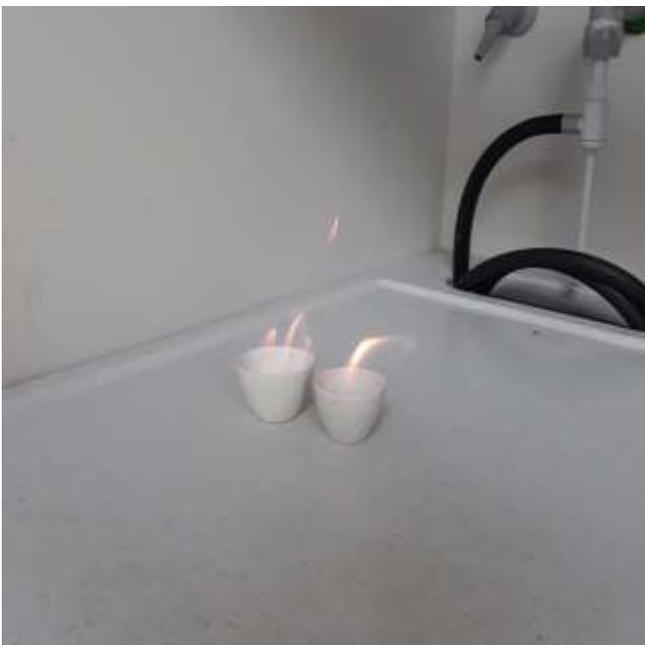
**Figura 3. Proceso de incineración para acelerar el análisis de cenizas.**
