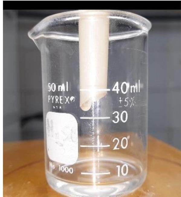
Figura 19. Filtrado del aloe vera se aprecia el color de la gota totalmente transparente indicación de no presencia de aloína
