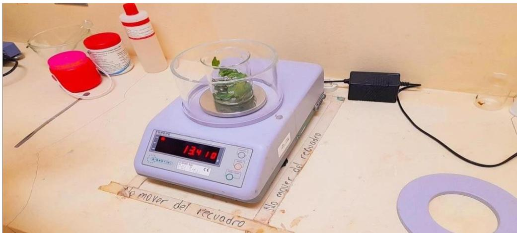
Figura 13. Equipo fundamental en el proceso de elaboración del producto balanza de peso en gramos (peaje de las hojas de mentas usadas en los primeros ensayos) porcentajes específicos de cada materia prima siguiendo los criterios sugeridos por los químicos.
