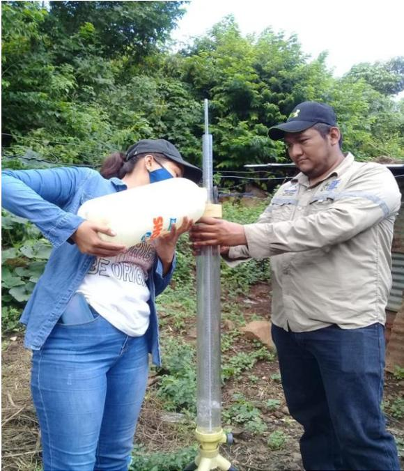
*Ilustración 3. Permeámetro de Guelph, prueba de infiltración. Fuente: propia*
