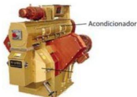
Ilustración 13 Peletizador, Acondicionador
