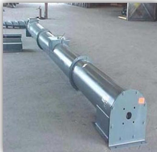
*Ilustración 7 Transportador de tornillo sin fin*
