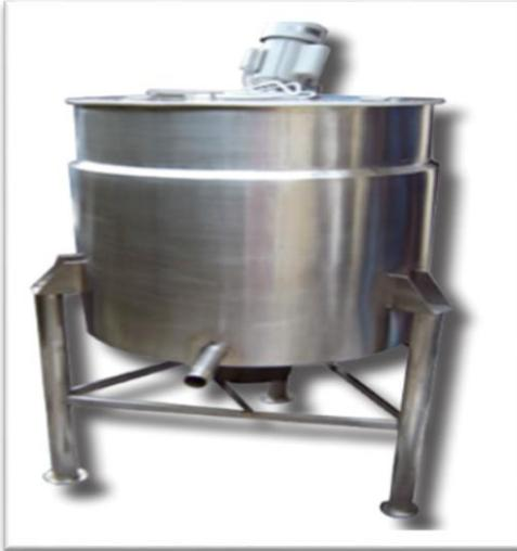
Equipo que permite efectuar diversas operaciones tales como pasteurización de la leche, cuaje para queso y maduración del yogurt. Esta construida en acero inoxidable, es una unidad compacta con tapa; posee una capacidad de 100 litros. (Arestegui, 2013)
