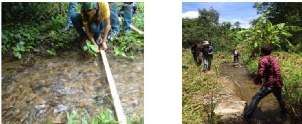
**Imagen 7.** Medición de caudales mediante el método de flotadores.
