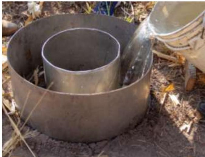
**Imagen 9.** Prueba de infiltración, método de infiltrómetro de doble anillo (método Müntz).
