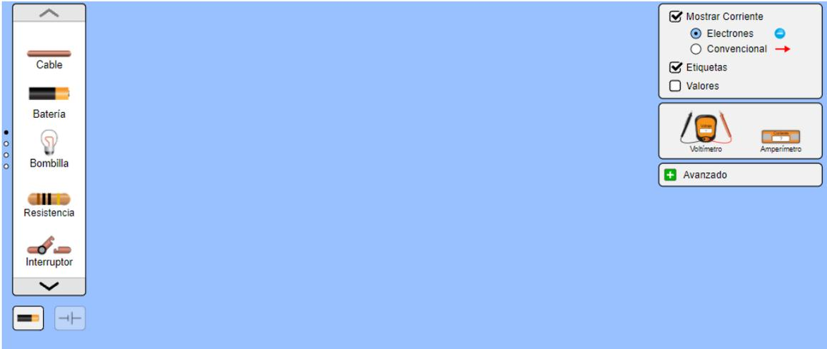
6. se inicia a construir el circuito para ellos utiliza una batería, cable, un interruptor y una bombilla, daremos clip en cada uno de los materiales y se desliza hacia el centro de la pantalla.
