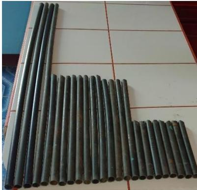
○ Con un taladro se le hace una vuelta a los tubos que serán pegados de manera horizontal, tanto para el plano como para las bases del plano, al no tener taladro se puede alizar un fierro caliente de medida 4/8 para darle forma a la boca del tubo, para facilitar al momento de pegar
