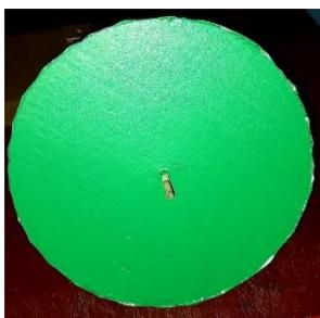
Se cortarán dos círculos los cuales van a ser la base superior e inferior del cilindro de un diámetro de 14 cm, a ambos círculos se les hará un orificio en el centro de cada uno por donde pasará el eje del cilindro.
