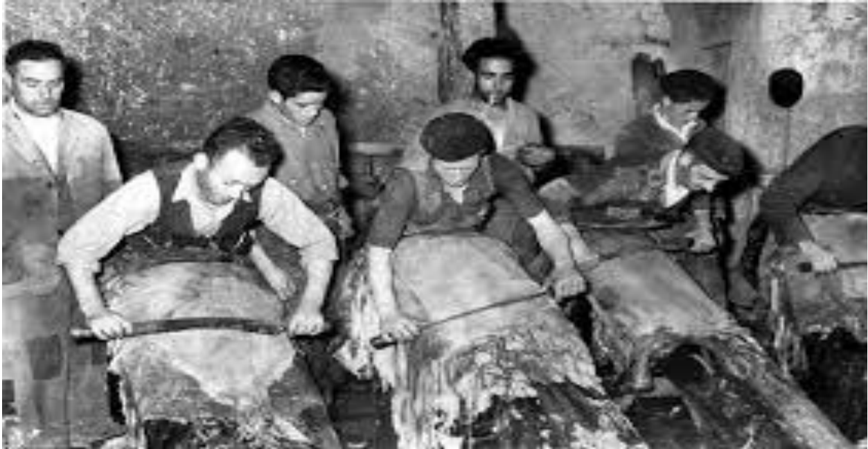
Proceso de descarne de manera artesanal
