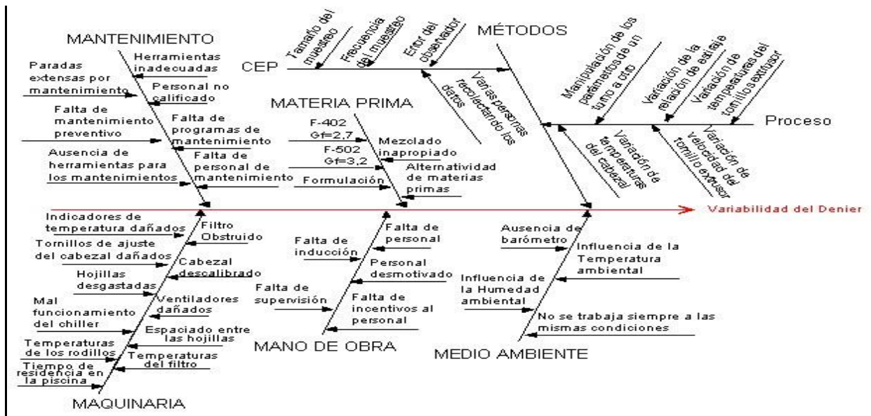
Figura 3.1 : Diagrama de Causa y Efecto de la Variabilidad del Denier
