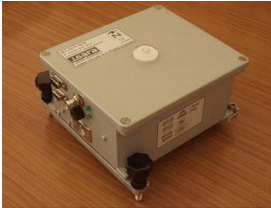
**Figura 5.3.2.2:** Sensor de un Sismómetro de periodo corto SARA de 4,50Hz de una y de tres componentes.
