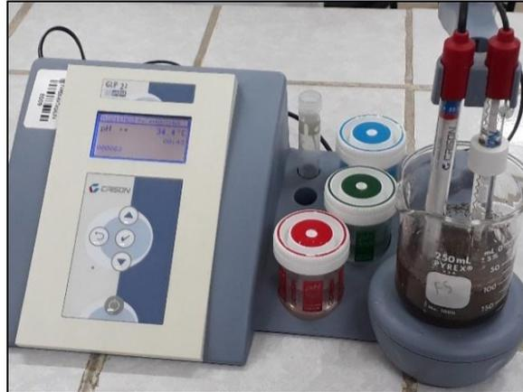
Figura 13. Prueba de pH con potenciómetro
