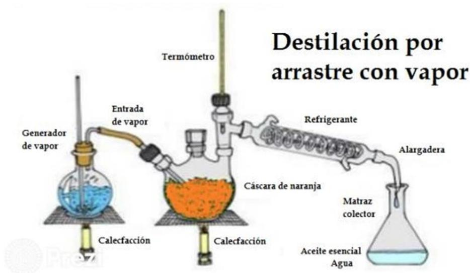
Figura 6: montaje del sistema de destilación para la extracción de aceites esenciales de la cascara de naranja. Fuente: (Unknown, 2014)
