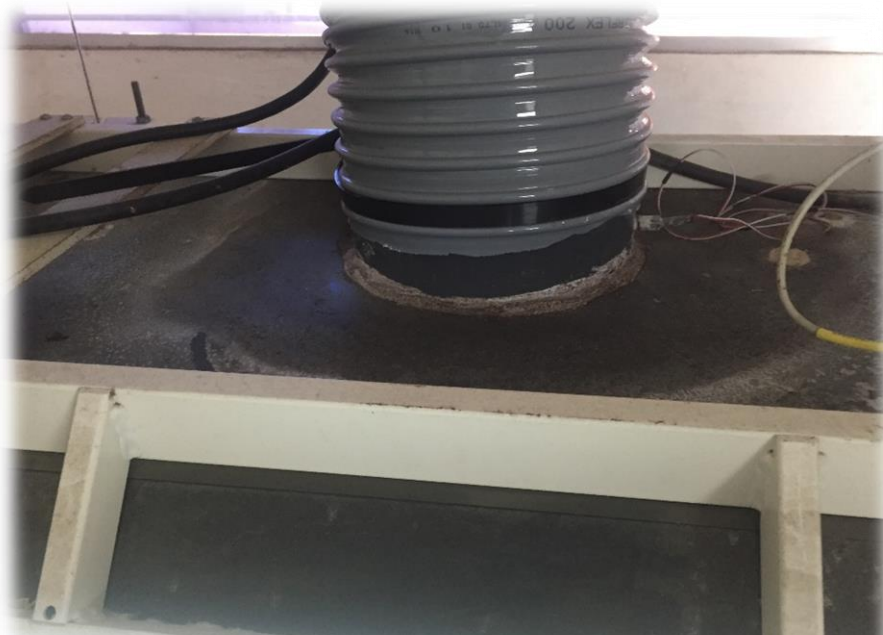
Ilustración 19. Cambio de faja de sujeción en el acople.
