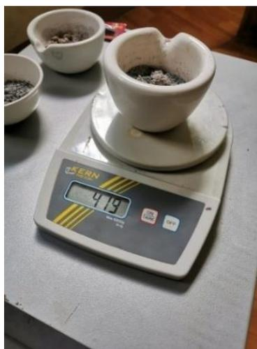
*Figura 10. Muestra Sacada del Horno*
