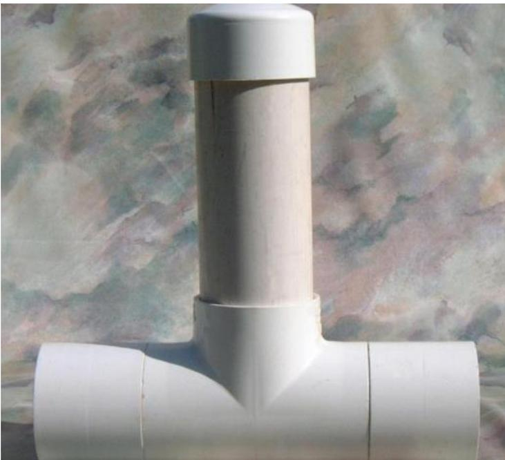
*Figura 12. Clorador de agua potable*
