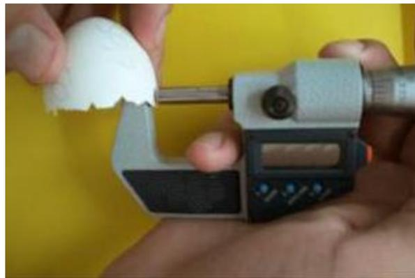
Imagen 24: Medición del espesor de la cáscara mediante el micrómetro, Fuente: <https://avicultura.info/determinacion-de-calidad-del-huevo/>
