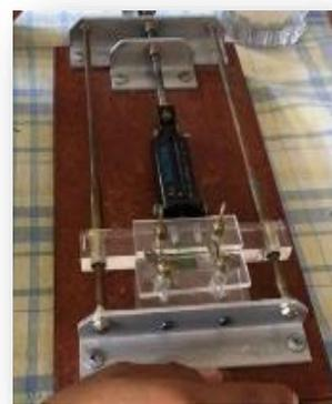
Figura 4. Tensiómetro
