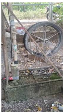
*Figura 4. Bomba de mecate.*
